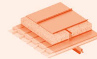
Sistema de aislamiento acústico (absorción de sonido) sobre chapa grecada no estructural
