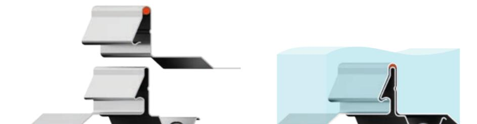
ELYROOF PLUS es un sistema diseñado para eliminar cualquier posible fuga en la sección de solapamiento de las bandejas, garantizando así una cubierta metálica completamente impermeable.
